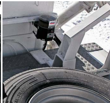
ЦСС на автобетононасосе CIFA K40 XRZ
